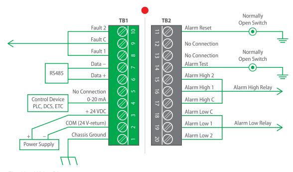
Fig. 16 Wiring Diagram
