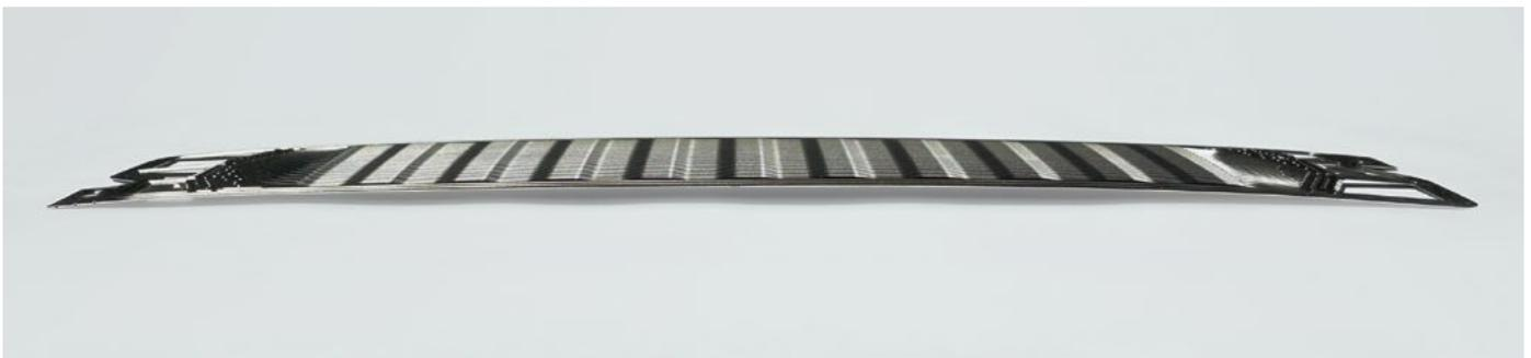
100 µm-Bipolarplatte, gerichtet
