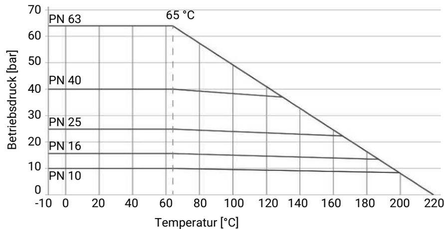
Druck-Temperatur-Angaben gemäß Diagramm beziehen sich auf statische Betriebsbedingungen. Stark schwankende oder zeitlich schnell wechselnde Parameter können zu einer Verringerung der Standzeit führen. Spezielle Anwendungen sind mit Ihrem technischen Ansprechpartner vorab durchzusprechen.
