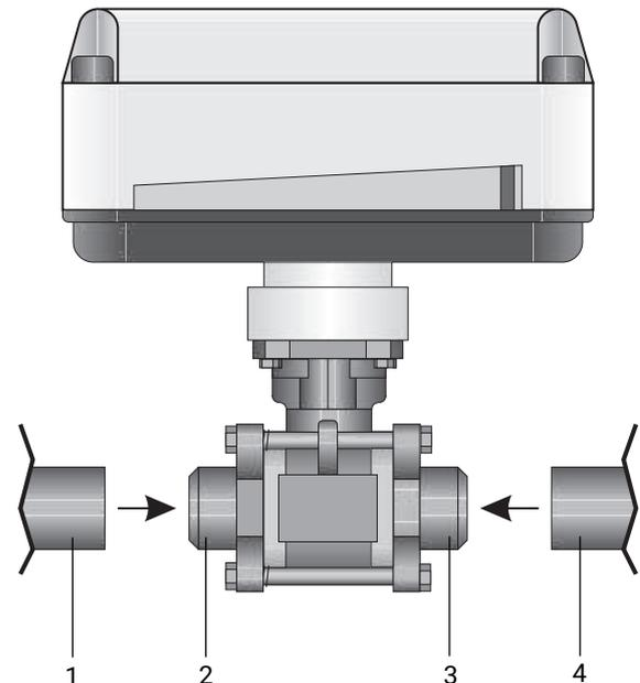
2. Rohrleitungen **1** und **4** links und rechts an den Schweißstutzen **2** und **3** ausrichten und anheften.
