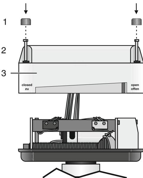
8. Abdeckung Antrieb 3 aufsetzen.
