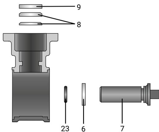
14. Dichtungen **9** und **8** nach oben aus dem Kugelhahn entnehmen.
