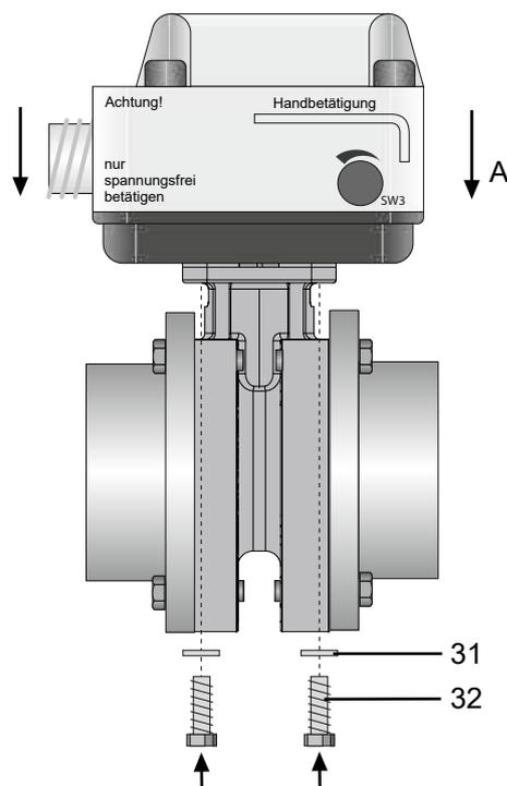
1. Neuen Antrieb **A** auf Kugelhahnkörper stecken.
