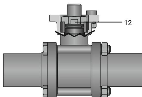
2. Lasche **12** der Schraubensicherung nach unten aufbiegen.
