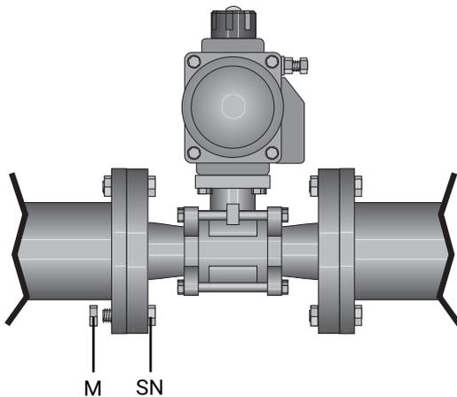
7. Schrauben **SN** in alle Löcher am Flansch einführen.
