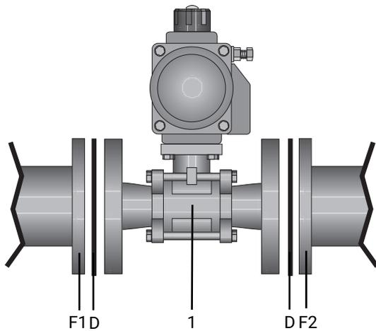
1. Auf saubere und unbeschädigte Dichtflächen der Anschlussflansche achten.
