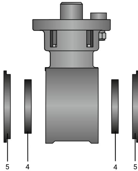
10. Dichtscheiben **5** und Sitzdichtung **4** auf beiden Seiten des Kugelhahns entnehmen.
