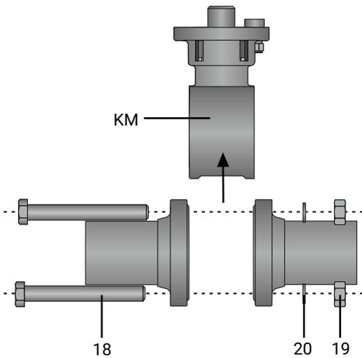
7. Muttern **19** der Flanschschrauben **18** des Kugelhahns lösen und mit Unterlegscheiben **20** abnehmen.
