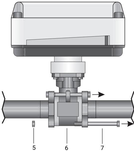
3. Muttern **5** ganz aufdrehen, bei der Schraube, die durch die Lasche führt, Mutter **5** nur lösen.
