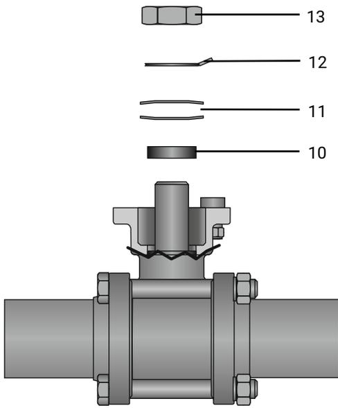
3. Spindelmutter **13** lösen und entnehmen.
