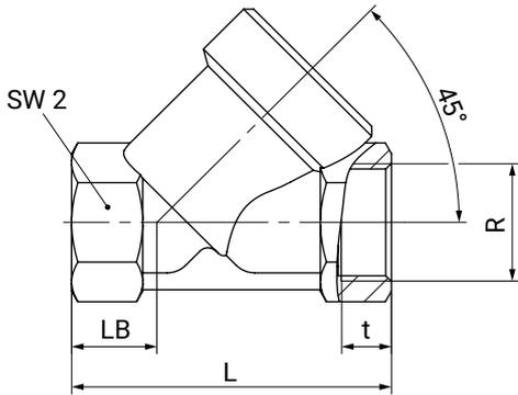
**Anschlussart Gewindemuffe DIN (Code 1)<sup>1)</sup>, Feingussmaterial (Code 37)<sup>2)</sup>**
