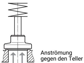
Die Durchflussrichtung ist durch einen Pfeil auf dem Ventilkörper gekennzeichnet.
