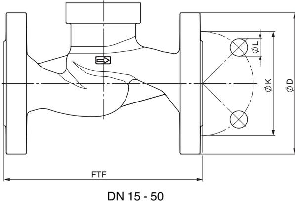
**Anschlussart Flansch Baulänge EN 558 (Code 39)<sup>1)</sup>, Feingussmaterial (Code 37), Sphärogussmaterial (Code 90)<sup>2)</sup>**
