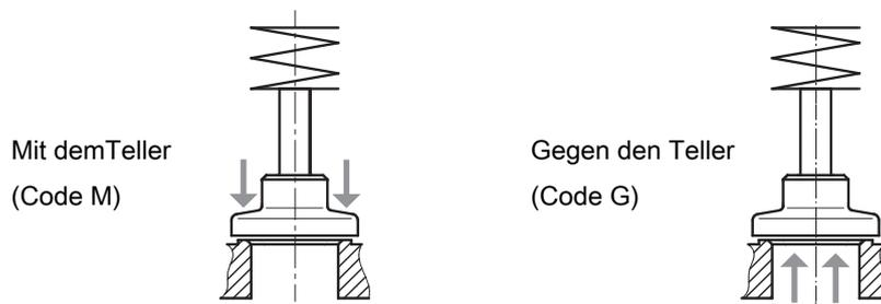
Gegen den Teller ist die zu bevorzugende Durchflussrichtung bei inkompressiblen, flüssigen Medien, um Wasserschläge zu vermeiden
