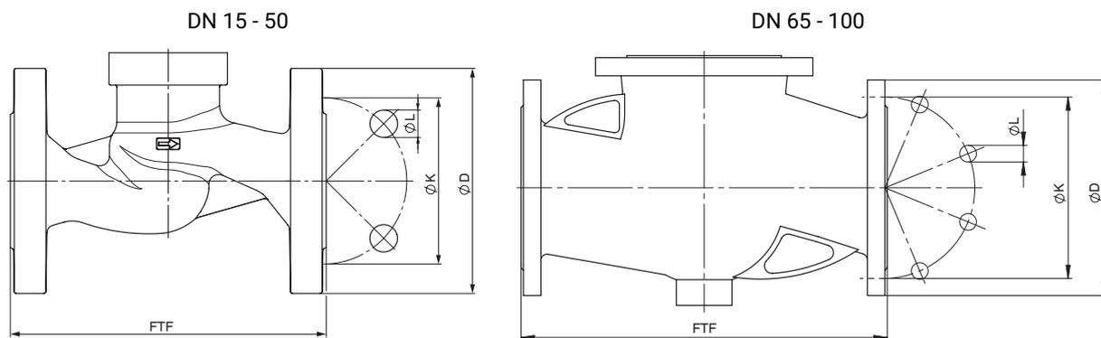
**Anschlussart Flansch Baulänge EN 558 (Code 39)<sup>1)</sup>, Feingussmaterial (Code 37), Sphärogussmaterial (Code 90)<sup>2)</sup>**
